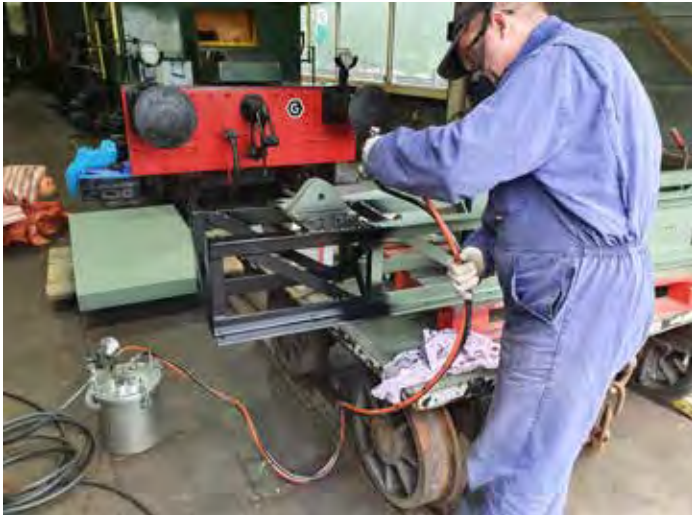
Eind oktober jl. zijn de onderdelen net in Simpelveld gearriveerd en worden ze door Diederik onder handen genomen. Na het in de primer spuiten, kon een dag later reeds de eerste laag zwarte aflak volgen. Foto Dion van der Born
