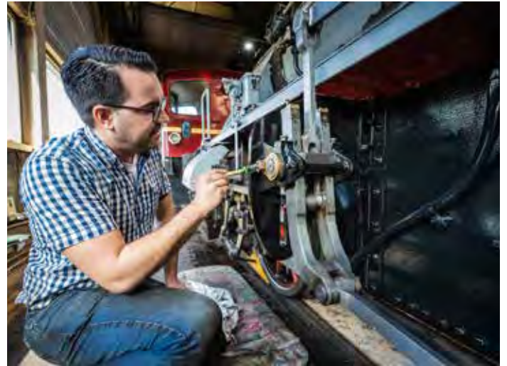
Machinist Niels voorziet de onderkant van een extra sterke verflaag.
